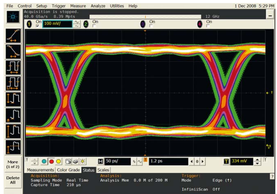
Rys. 2. Sygnał PCI Express Gen II obserwowany w paśmie 13 GHz przy czasie narastania 60ps
